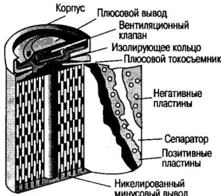
Рис. 2.2. Устройство никель-кадмие-вого аккумулятора
