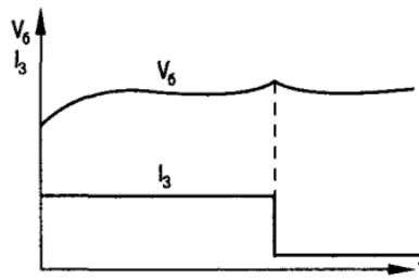
Рис. 2.17. Временная характеристика работы устройства быстрого заряда
