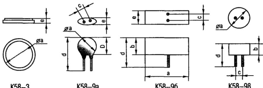
Рис. 5.2. Внешний вид ионисторов отечественного производства
