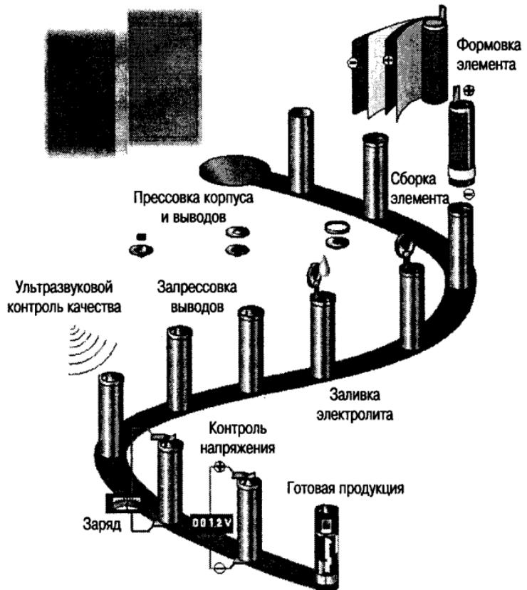
Рис. 2.4. Процесс производства никель-металлгидридных аккумуляторов
