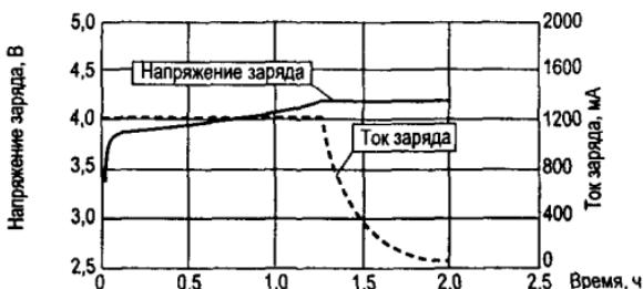
Рис. 4.6. График цикла заряда литий-ионного аккумулятора
