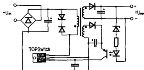
Рис. 9.1. Типовое включение TOPSwitch
