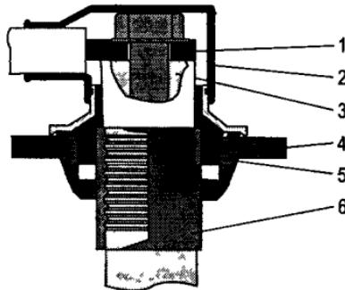
Рис. 3.15. Токоведущие выводы герметизированных аккумуляторов Varta
