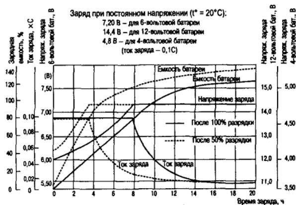
Рис. 3.6. Характеристики заряда при разряде батарей на 50 и 100 %
