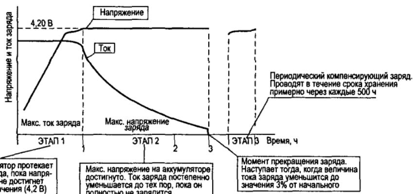
Рис. 4.7. Обобщенный график цикла заряда литий-ионных аккумуляторов
