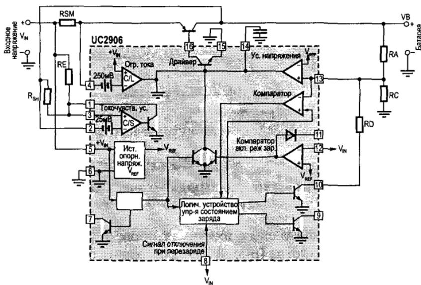
Рис. 8.21. Схема зарядного устройства двухступенчатого компенсационного заряда
