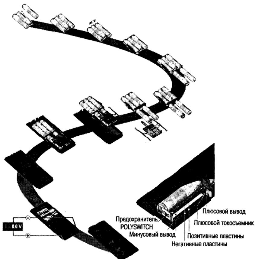
Рис. 2.6. Процесс сборки аккумуляторных батарей для мобильных телефонов (пример)
