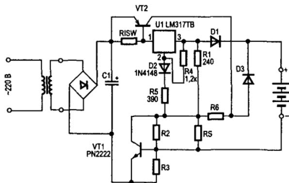
Рис. 8.17. Принципиальная схема устройства двухступенчатого заряда
