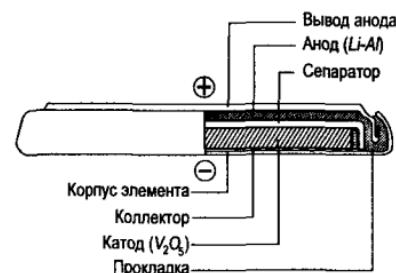
Рис. 4.5. Устройство таблеточного литий-ионного аккумулятора
