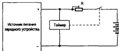
Рис. 8.1. Простейшее устройство для заряда никель-кадмийевых и никель-металлгидридных аккумуляторов
