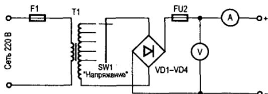
Рис. 8.12. Схема простого зарядного устройства свинцово-кислотных аккумуляторных батарей
