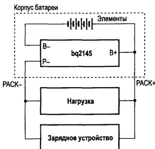
Рис. 8.10. Схема подключения модуля bq2145
