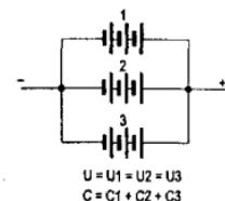
Рис. 7.7. Параллельное соединение аккумуляторных батареи
