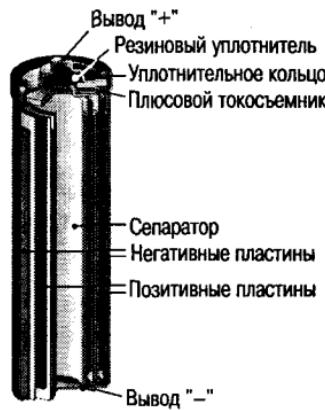
Рис. 2.3. Устройство никель-металлгидридного аккумулятора
