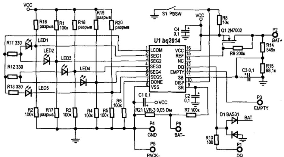
Рис. 8.8. Принципиальная схема устройства контроля емкости никель-металлгидридных батарей
