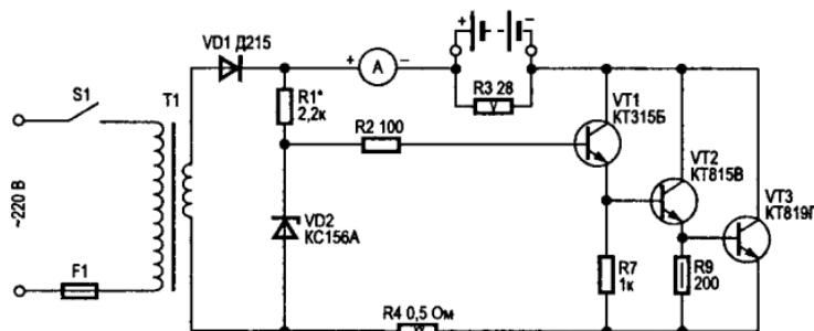
Рис. 8.16. Принципиальная схема устройства заряда асимметричным током
