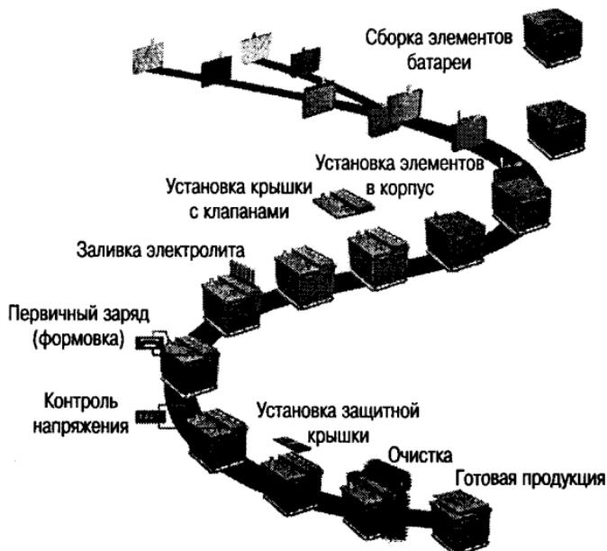
Рис. 3.4. Цикл производства автомобильных свинцово-кислотных батарей (пример)
