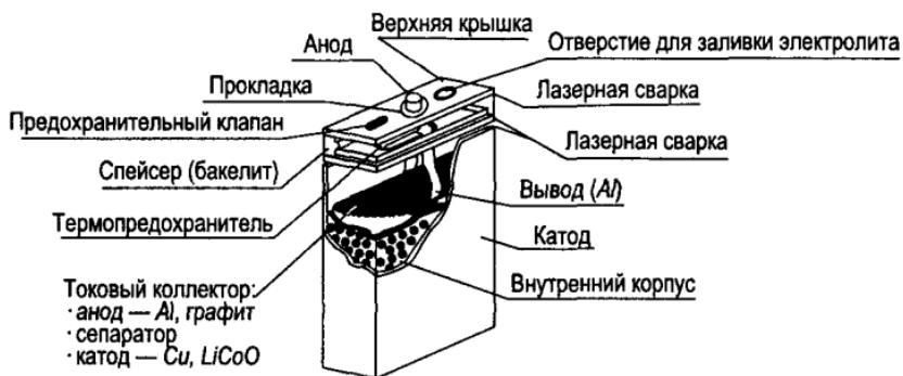
Рис. 4.3. Конструкция литий-ионного аккумулятора в призматическом корпусе
