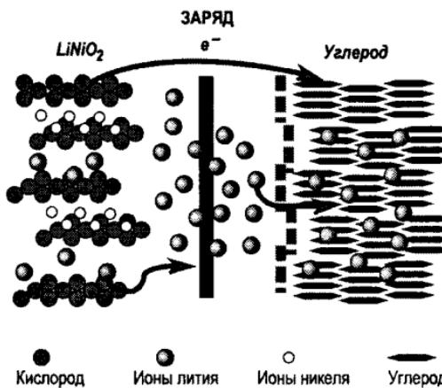
Рис. 4.2. Процесс заряда литий-ионного аккумулятора
