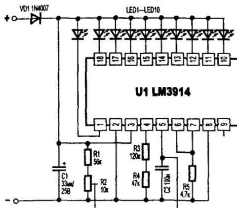
Рис. 8.24. Монитор состояния 12-вольтовой свинцово-кислотной батареи
