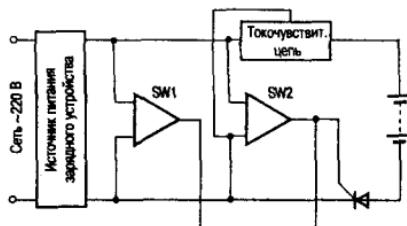
Рис. 3.8. Структурная схема зарядного устройства для двухступенчатого заряда
