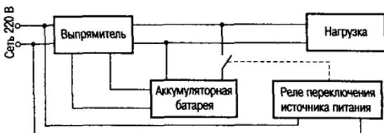
Рис. 3.10. Структурная схема источника бесперебойного питания
