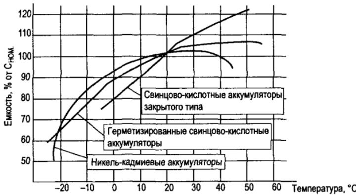
Рис. 7.9. Зависимость отдаваемой аккумуляторами емкости от температуры
