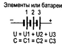
Рис. 7.6. Последовательное соединение аккумуляторов в батарею
