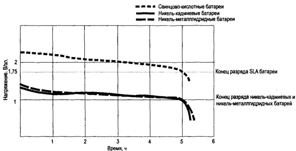
Рис. 7.1. Характеристики разряда никель-кадмийевых и свинцово-кислотных батареи
