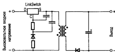
Рис. 9.6. Типовое включение LinkSwitch
