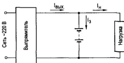
Рис. 3.11. Система с зарядкой батареи методом плавающего заряда
