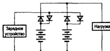
Рис. 7.8. Развязка ветвей аккумуляторной батареи при помощи диодов
