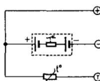
Рис. 2.21. Внутренняя схема аккумуляторной батареи, предназначеннной для работы со скоростным  $\Delta T$ -зарядным устройством
