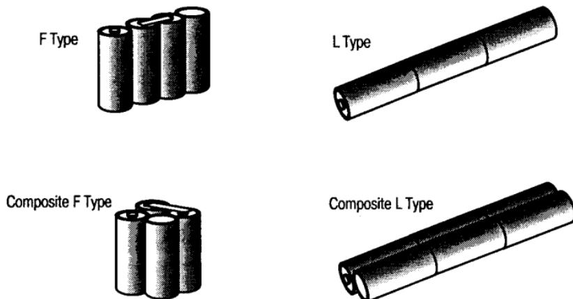
Рис. 2.7. Типы аккумуляторных батарей производства фирмы Panasonic
