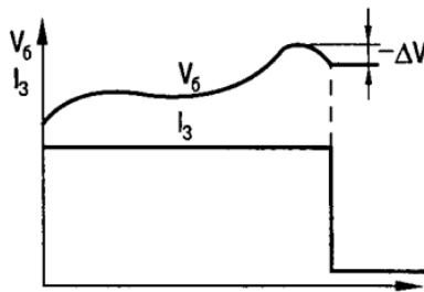
Рис. 2.18. Временная характеристика  $\Delta V$ -заряда
