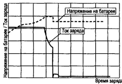
Рис. 3.9. Характеристики двухступенчатого заряда
