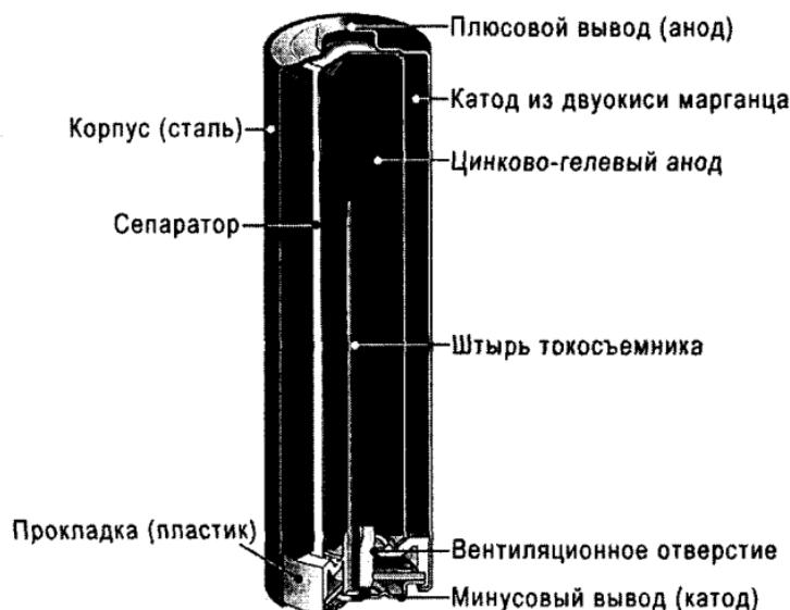
Рис. 5.1. Устройство алкалинового элемента
