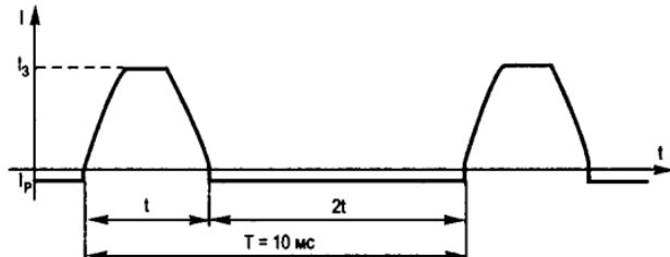
Рис. 8.15. Форма импульсов асимметричного тока заряда
