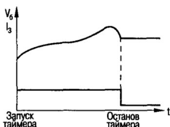
Рис. 2.15. Временная характеристика заряда с управлением по таймеру
