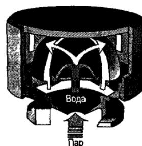
Рис. 3.14. Конструкция пробки с каталитическими насадками батареи Varta
