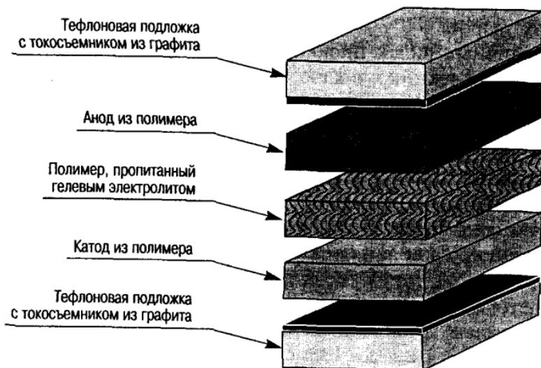
Рис. 4.4. Пакетные элементы литий-ионных батарей
