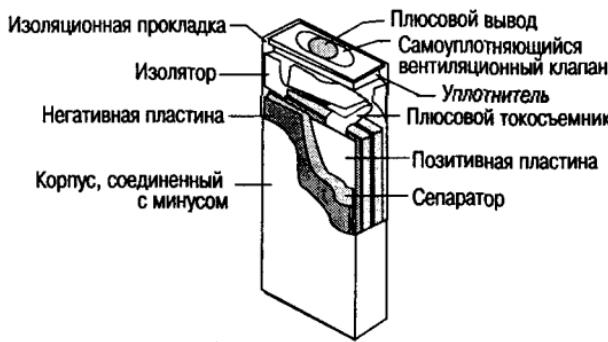
Рис. 2.5. Конструкция призматического аккумулятора
