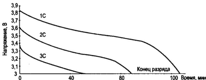
Рис. 7.4. Разрядные характеристики литий-ионной батареи мобильного телефона
