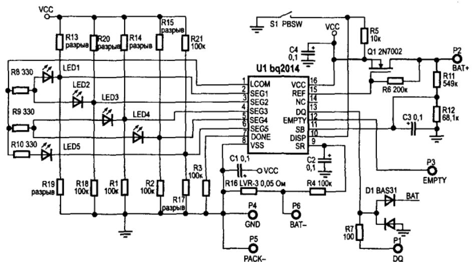
Рис. 8.9. Принципиальная схема устройства контроля емкости литий-ионных батарей
