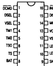
Рис. 8.4. Расположение выводов микросхемы bq2004
