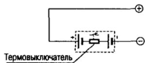
Рис. 2.20. Внутренняя схема аккумуляторной батареи, предназначеннной для работы с ЗУ скоростного  $\Delta V$ -заряда
