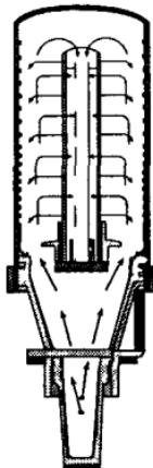
Рис. 3.16. Конструкция пробки аккумулятора AquaGen® фирмы HOPPESCKE
