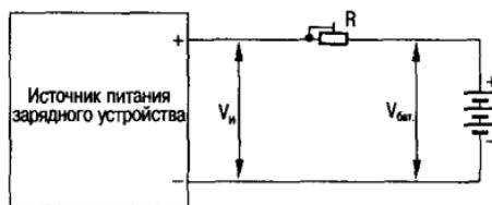
Рис. 2.11. Схема зарядного устройства нормального заряда
