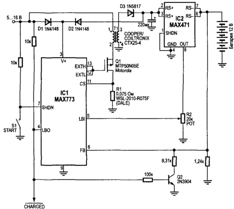
Рис. 8.18. Схема зарядного устройства на микросхемах MAXIM
