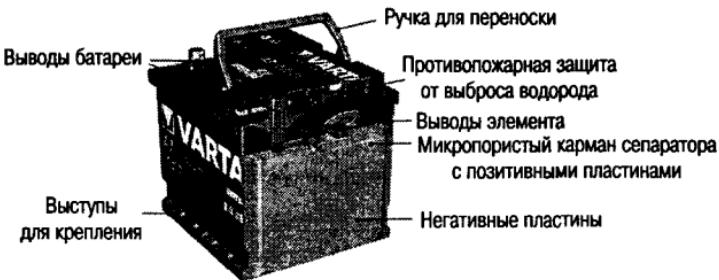
Рис. 3.3. Устройство автомобильной батареи Varta
