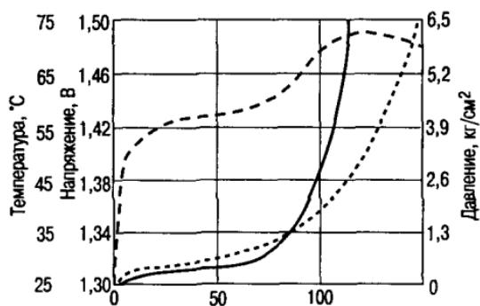
Рис. 2.22. Зарядные характеристики никель-кадмиеового аккумулятора
