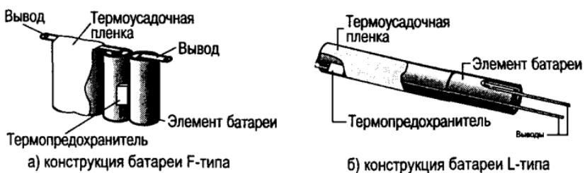
Рис. 2.8. Конструкция аккумуляторных батарей L- и F-типов
