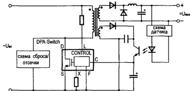
Рис. 9.5. Типовое включение DPA-Switch
