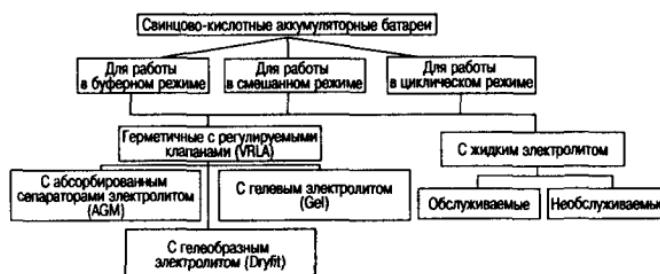
Рис. 3.1. Виды свинцово-кислотных аккумуляторных батарей
