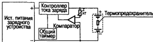
Рис. 2.16. Структурная схема устройства быстрого заряда
