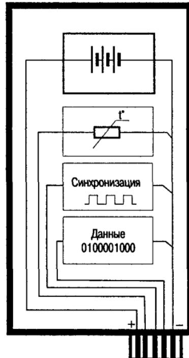
Рис. 6.2. Структурная схема Smart-батареи с шиной SMBus
