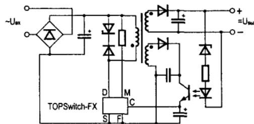
Рис. 9.3. Типовое включение TOPSwitch-FX
