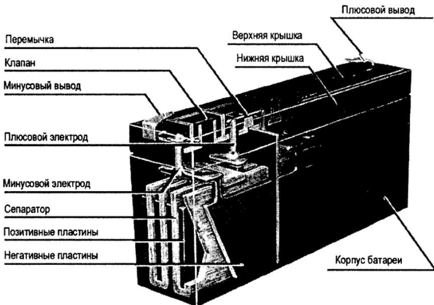
Рис. 3.2. Устройство VRLA батареи Panasonic
