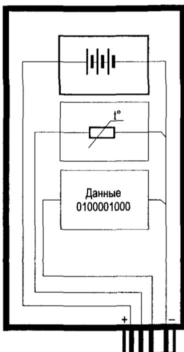
Рис. 6.1. Структурная схема Smart-батареи с 1-проводным интерфейсом 1-Wire®
