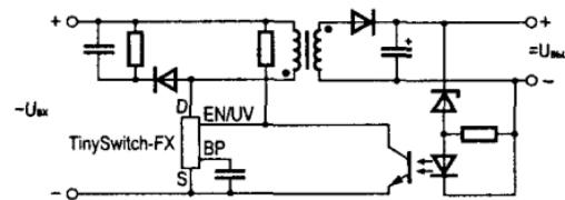
Рис. 9.4. Типовое включение TinySwitch-FX
