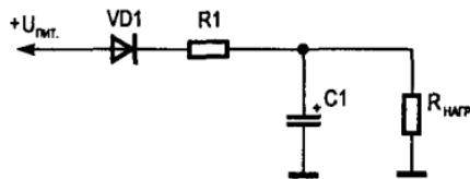
Рис. 5.4. Схема зарядной цепи ионистора
