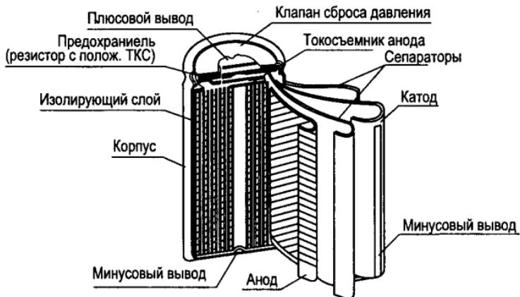
Рис. 4.1. Устройство литий-ионного аккумулятора
