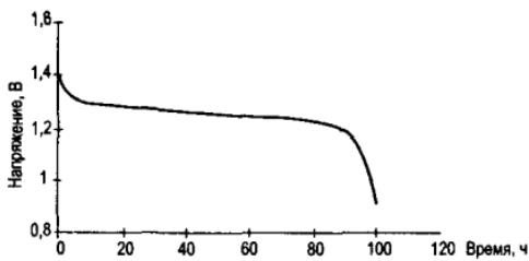
Рис. 7.5. Разрядная характеристика никель-кадмийового аккумулятора
