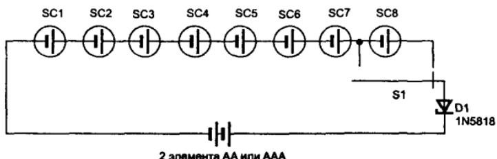
Рис. 8.22. Зарядное устройство на солнечных элементах
