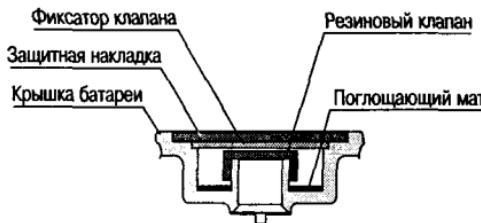
Рис. 3.5. Пример конструкции предохранительного клапана
