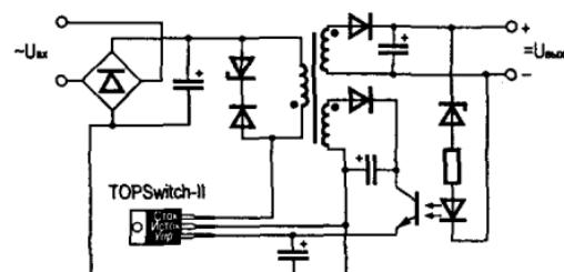
Рис. 9.2. Типовое включение TOPSwitch-II
