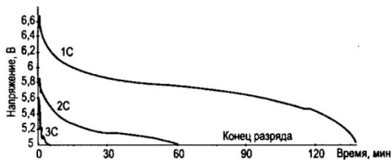
Рис. 7.3. Разрядные характеристики никель-металлгидридной батареи мобильного телефона
