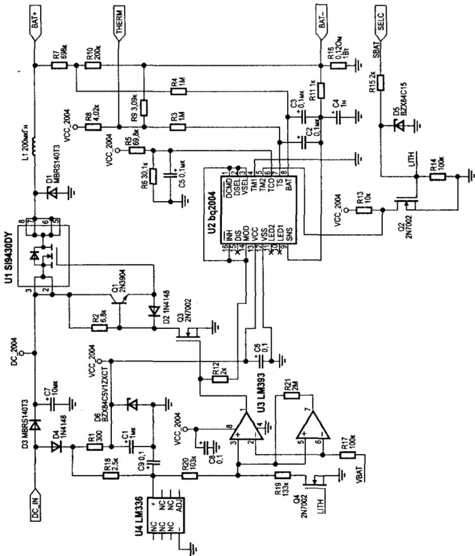
Метод заряда никель-металлгидридных батарей — быстрый заряд с отключением по методу  $\Delta T$ . Катушка L1 намотана на тороидальном сердечнике ST50-267 производства фирмы MICROMETALS и содержит 70 витков провода диаметром AWG22<sup>4</sup>. Начальное значение ее индуктивности — 3 мГн. При необходимости увеличить ток заряда индуктивность следует уменьшать. Частота переключения составляет около 30 кГц.
