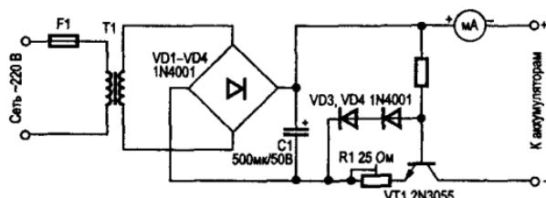
Рис. 8.23. Простое устройство для заряда никель-кадмийевых аккумуляторов
