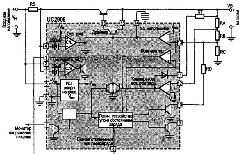
Рис. 8.20. Схема зарядного устройства двухступенчатого плавающего заряда
