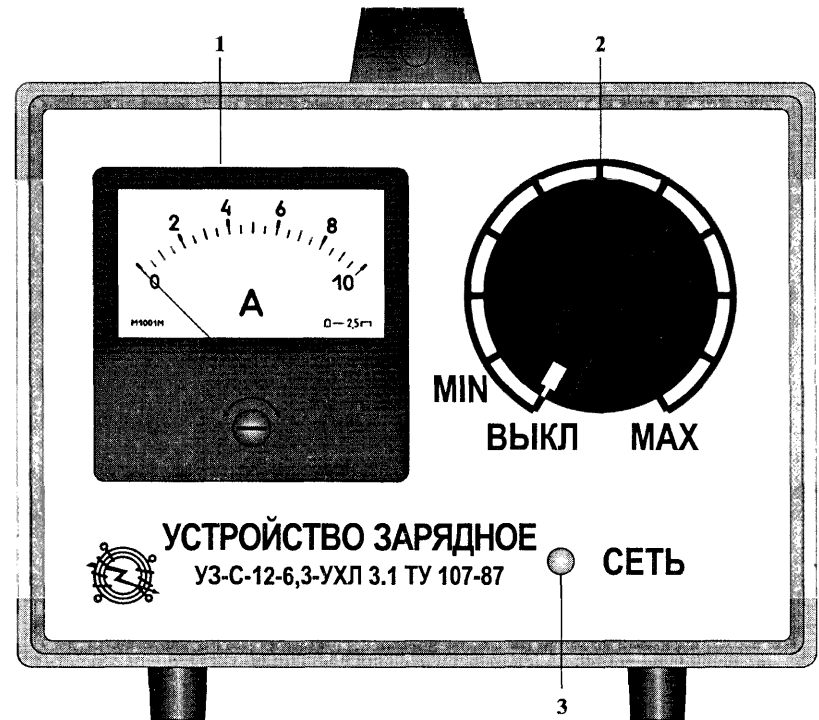
Рис. 2.21. Внешний вид устройства зарядного (масштаб 1:1,25).
