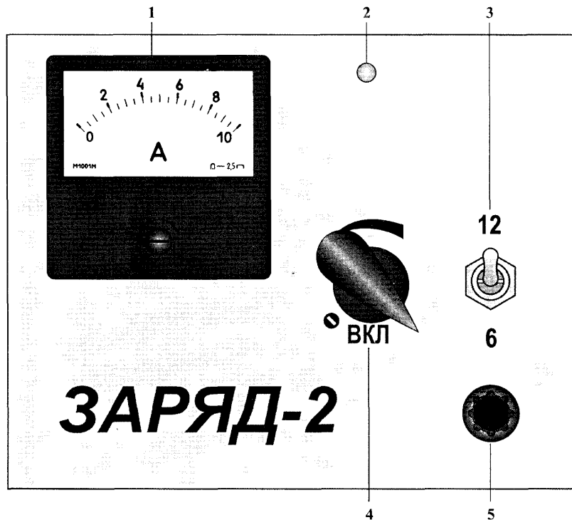
Рис. 2.30. Внешний вид устройства зарядного (масштаб 1:1,25).
